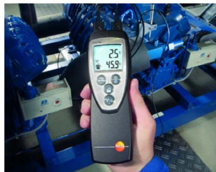
Одновременное измерение с testo 922 перегрева и переохлаждения в холодильных системах
