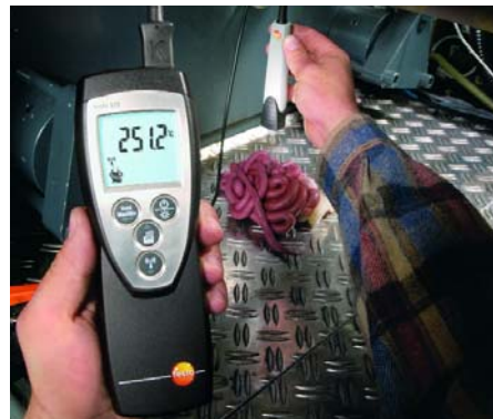
Измерение температуры в полутвердых материалах с помощью супер быстрого проникающего зонда, идеален для пластика и пищевых продуктов ит.д.
